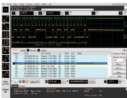
Запуск и просмотр декодированных пакетов последовательной шины I2C
