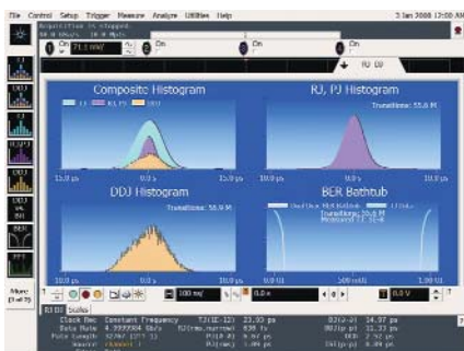
Анализ джиттера плюс выделение RJ/DJ
