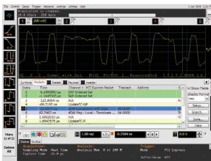
Запуск и декодирование пакетов последовательной шины PCIe
